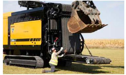
**ACCESIBILIDAD A LA CINTA INFERIOR.** Reduce el tiempo de mantenimiento gracias a una única cinta inferior que se puede extraer sin necesidad de separarla de la cinta de descarga. Ahorra tiempo durante las intervenciones y mantenimiento de este componente fundamental que necesita a menudo controles.
