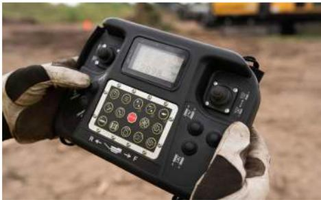
**RADIO COMANDO FULL-FUNCTION.** Controla los ajustes del trabajo de la máquina, visualiza los datos de trabajo y comprueba la diagnostica gracias al listado de los códigos de error del equipo, todo esto gracias al radio comando.
