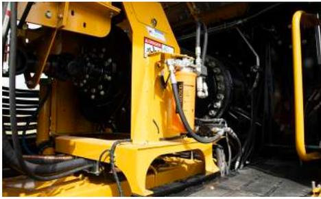
**TRANSMISION MECANICA DIRECTA Y PROTECCION.** Maximiza la eficiencia con la transmisión mecánica directa reversible que garantiza la máxima fuerza al rotor.
