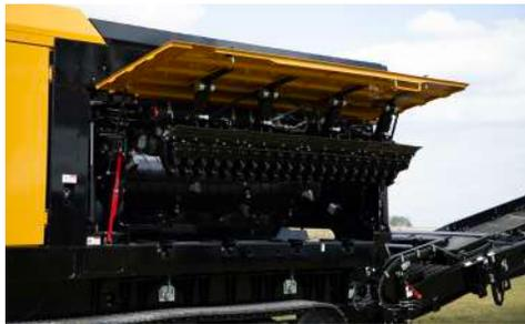
**ACCESO TOTAL AL ROTOR.** El panel lateral con apertura hidráulica garantiza la accesibilidad total al rotor, al peine y a la cinta inferior, para reducir los tiempos de mantenimiento. Esta área está creada para permitirte hacer el mantenimiento sin obstáculos.
