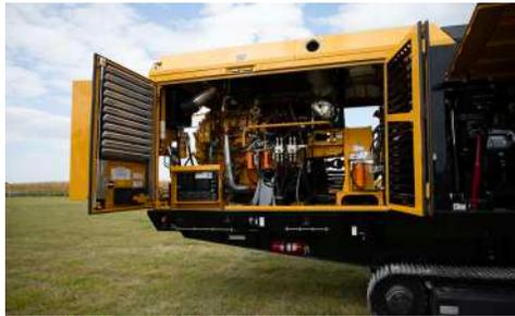
**ACCESIBILIDAD AL MOTOR.** El LS3600TX ofrece una accesibilidad sin iguales a todos los paneles de la máquina. El diseño del motor tiene una accesibilidad fácil y cómoda para las operaciones de mantenimiento, gracias a paneles anchos y una plataforma amplia para facilitar el trabajo.
