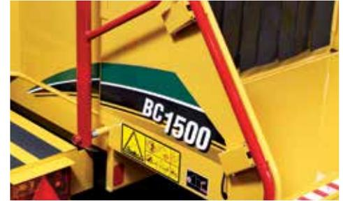
**MESA DE ALIMENTACIÓN.** Montada sobre la mesa de alimentación, la barra de control de alimentación superior de cuatro posiciones permite que el operador detenga los rodillos de alimentación y seleccione la marcha hacia adelante o en reversa. La barra de detención de alimentación inferior patentada está ubicada estratégicamente para posibilitar que la pierna del operador golpee la barra y apague el mecanismo de manera intencional o automática en una situación de emergencia.
