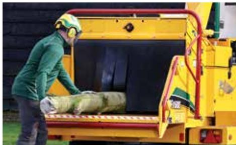
**SMARTFEED.** El sistema SmartFeed controla las rpm del motor y detiene e invierte automáticamente los rodillos de alimentación para mejorar la producción. Este sistema también detecta los atascos del rodillo de alimentación y manipula automáticamente el material para reducir la necesidad de utilizar la barra de control manual.
