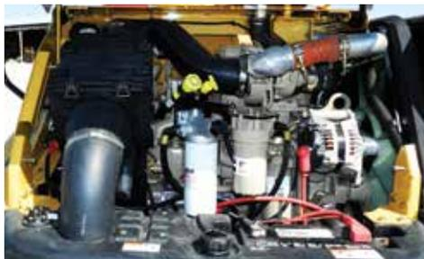
**MOTOR.** Alimentado por un motor Cummins Etapa IIIB de 97 kW (130 hp), la BC1500 puede manipular los materiales más difíciles con facilidad. Características, como el sistema de control del motor Ecolde™, que hace funcionar con poca potencia el motor automáticamente después de un minuto o cinco minutos de inactividad, reduce el ruido, las emisiones de gases de efecto invernadero y mejora la eficiencia del combustible.
